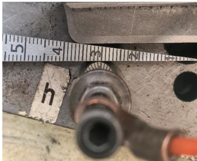
Figura 10 Mal posicionamiento de instrumento de medición
